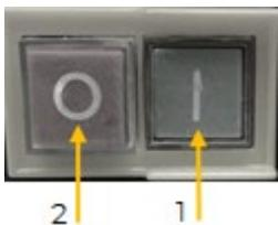
**Einschalten:** Drücken Sie die Einschalttaste der Schalteinheit (1).
