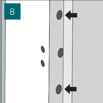
**DE** Verwenden Sie einen 10 mm Bohrer. Wenn Sie dickere Schrauben verwenden, passen Sie den Ø des Bohrers der Schraubengröße an.
