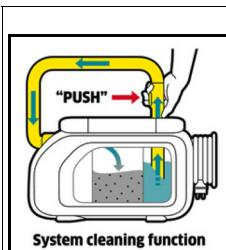
Le symbole pour le nettoyage du système après l'utilisation se trouvent sur l'intérieur du réservoir d'eau propre :
