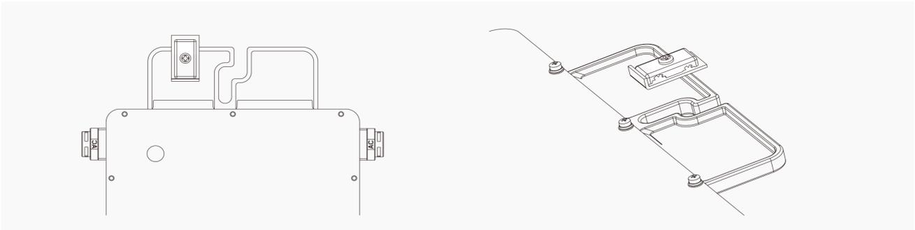
Verlegen Sie für jeden Mikrowechselrichter ein durchgehendes Erdungskabel durch die Erdungswinkel zu der den örtlichen Vorschriften entsprechenden AC-Erdungselektrode.
