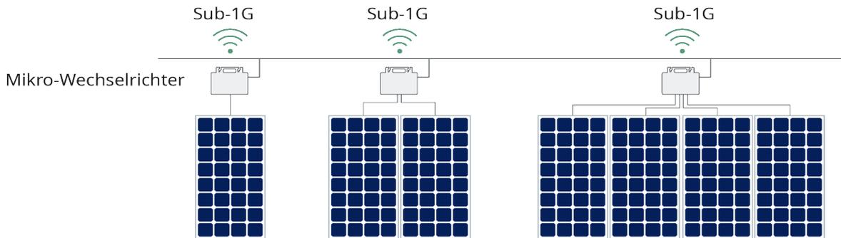
In diesem Benutzerhandbuch geht es um einen 1-in-1-Mikro-Wechselrichter von Hoymiles. Mit einer Ausgangsleistung von bis zu 500 VA zählt die Hoymiles neue Mikro-Wechselrichter-Serie HMS-500 zu den leistungsstärksten 1-in-1-Mikro-Wechselrichtern.
