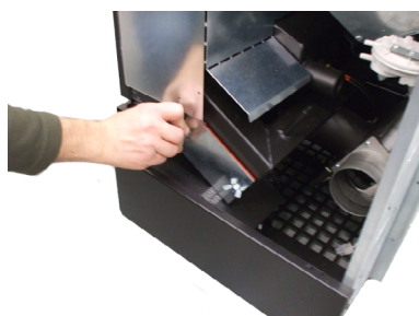
Fig. 82 - Chambre des fumées
