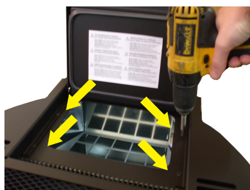
Fig. 71 - Enlèvement des vis du couvercle 2
