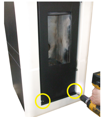
Fig. 27 - Fixation du panneau frontal
