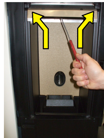
Fig. 81 - Nettoyer les deux conduits
