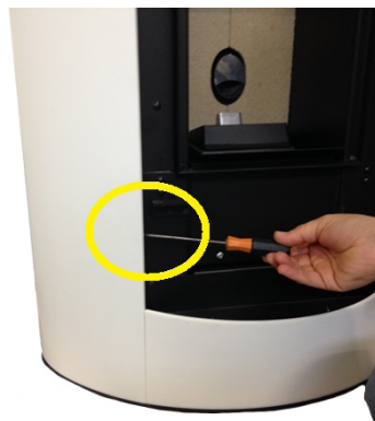
Fig. 77 - Desserrer la vis inférieure
