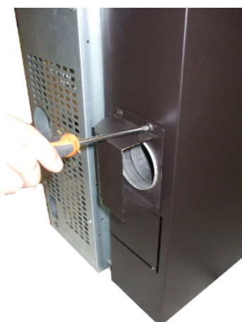
Fig. 53 - Montage du diffuseur
