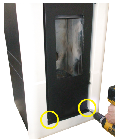
Fig. 41 - Fixation du panneau frontal
