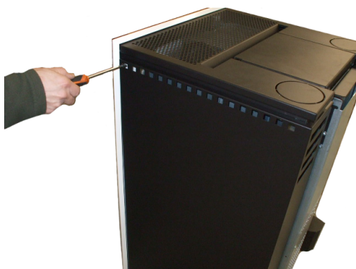
Fig. 64 - Retrait vis supérieure
