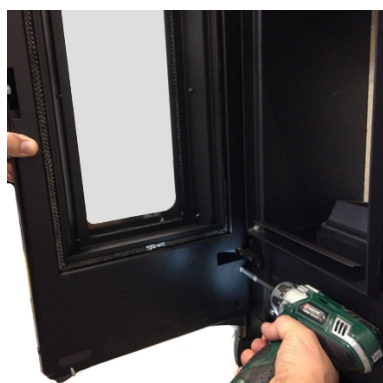
Fig. 74 - Desserrer la vis
