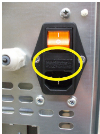
Fig. 91 - Hublot avec les fusibles à enlever
