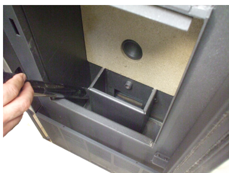
Fig. 61 - Nettoyage l'espace du brasero
