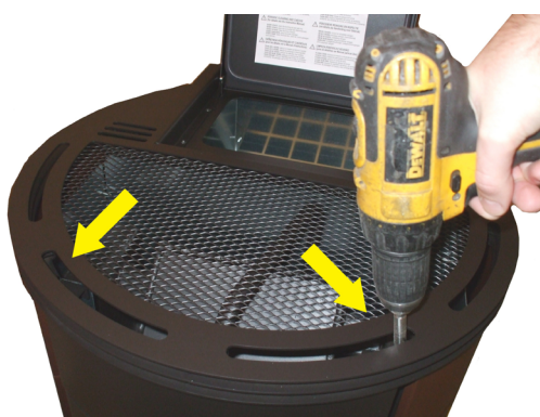
Fig. 70 - Enlèvement des vis du couvercle 1
