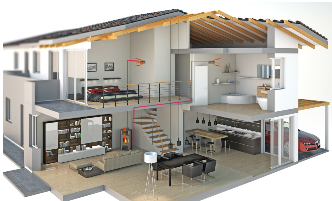
Fig. 52 - Exemple de canalisation
