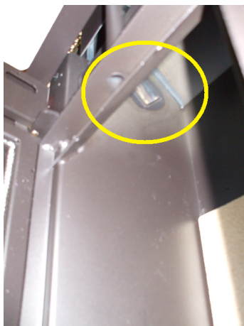
Fig. 79 - Passages des fumées
