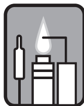
Illus. 4b : La flamme du contrôleur brûle correctement
