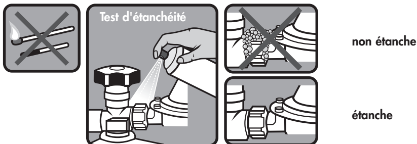
Illus. 2: Test d'étanchéité
