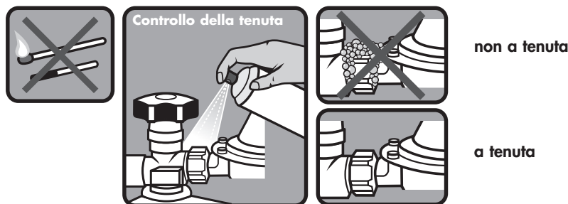
Fig. 3: Controllo della tenuta
