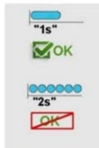
**FR** Appuyer pendant 2s sur le bouton au dos du contrôleur, lorsque le voyant bleu clignote, appuyer 2s sur le bouton de l'interrupteur à jumeler. Répéter l'opération en cas d'échec.
