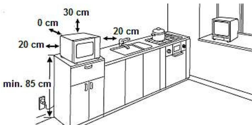
3. Die Rückseite des Geräts muss gegen eine Wand ausgerichtet sein.
