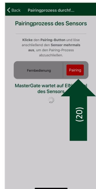
**Bitte beachte des Weiteres bei dem Pairing von Infrarotgeräten, zwischen dem Betätigen des anzulernenden Befehls ca. 0,5 Sekunden abzuwarten. Richte hierfür die anzulernende Infrarotfernbedienung im rechten Winkel, mittig auf die Status LED von intertechno MasterGate.**
