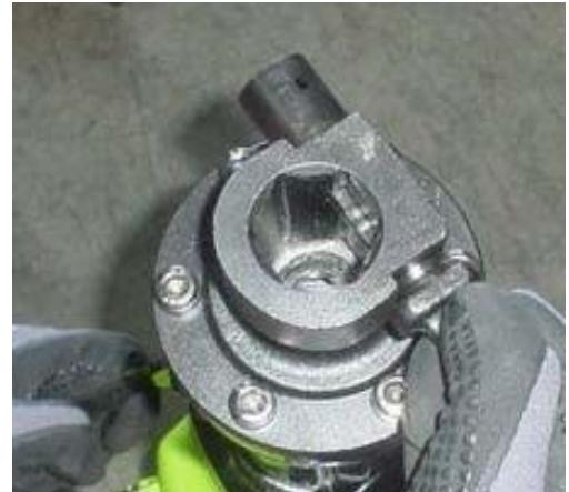
Inserire l'attrezzo e ruotare indietro il bullone di bloccaggio di 90 ° e farlo rientrare nel gambo dell'utensile.
