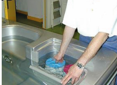
Filter lösen durch eine Linksdrehung
