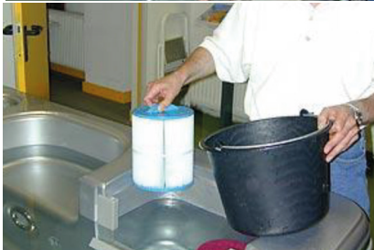
Filter entnehmen und in einen Eimer stellen. Kaltes Wasser begeben bis der Filter bedeckt ist.
