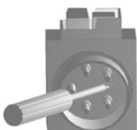
Bij draaistroommotoren kunt u de draairichting wijzigen door een schroovedraaier in de hiervoor bedoelde sleuf in de stekkraag te voeren. Stel vervolgens de draairichting in door met lichte druk naar links of rechts te draaien.
