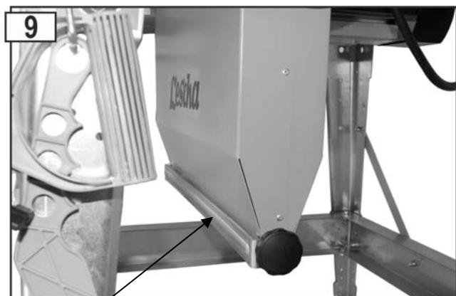
Spanausrutschlitz offen (Betrieb ohne Späneabsaugvorrichtung)
