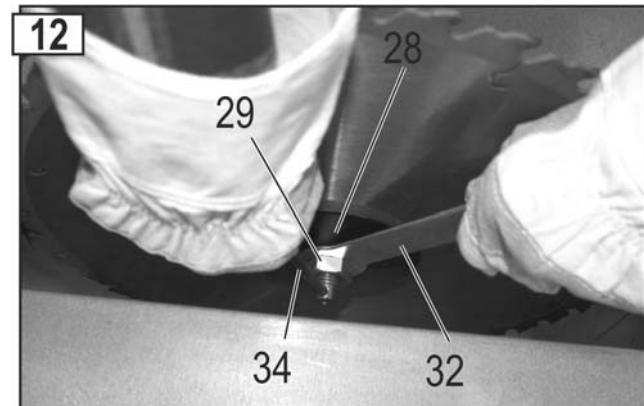
5. Jetzt können Sie den vorderen Sägeblattflansch (28) und das Sägeblatt (27) abnehmen.
