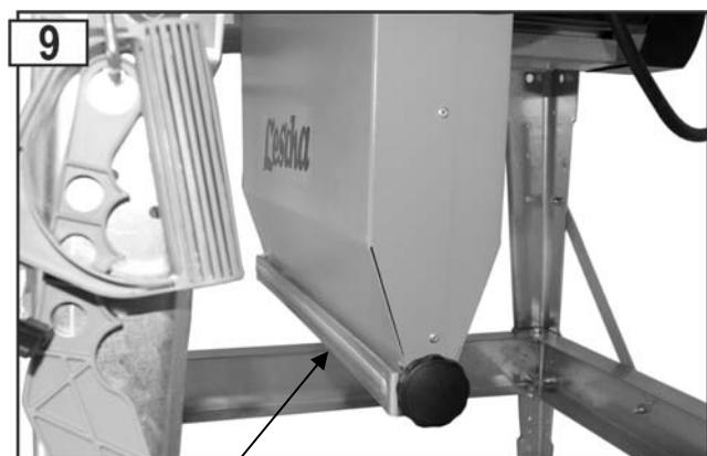
Vyhadzovací otvor pre piliny je otvorený (prevádzka bez odsávacieho zariadenia).
