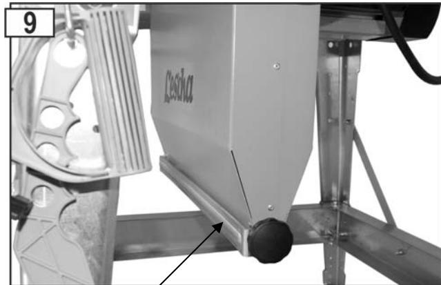
Fanta de eliminare a rumegușului deschisă (funcționarea fără dispozitivul de aspirare a rumegușului)
