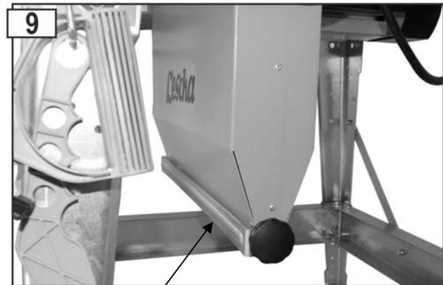
Výhuzový otvor pro piliny je otevřen(provoz bez odsávacího zařízení).
