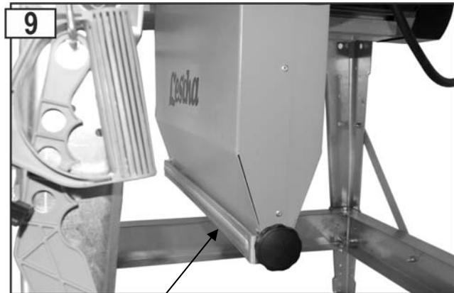
Spanenafvalseuf open (bedrijf zonder spanenafzuigvoorziening)
