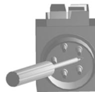
Bei Drehstrommotoren können Sie die Drehrichtung ändern, indem Sie einen Schraubendreher in den hierfür vorgesehenen Schlitz im Steckerkragen führen und mit leichtem Druck durch Links- oder Rechtsdrehung die richtige Drehrichtung einstellen.
