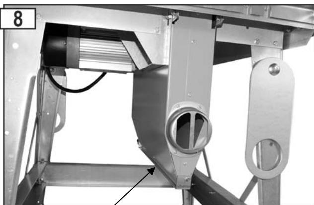
Výhuzový otvor pro piliny je uzavřen(použití s odsávacím zařízením)
