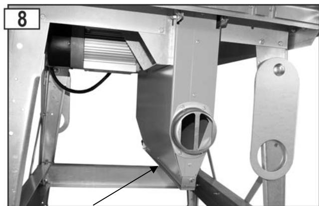
Vyhadzovací otvor pre piliny je uzavorený (použitie s odsávacím zariadením)
