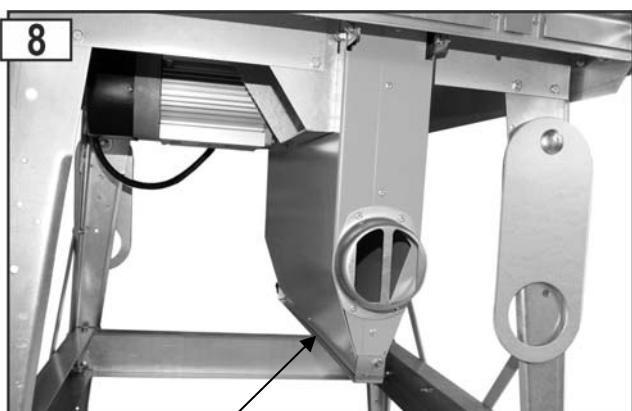
Fanta de eliminare a rumegușului închisă (funcționarea cu dispozitivul de aspirare a rumegușului)
