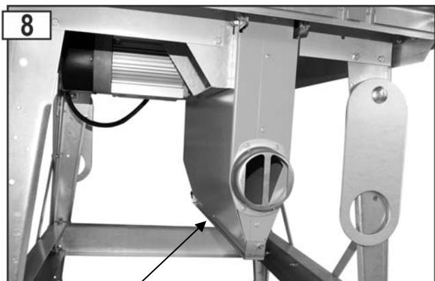
Spanenafvalseuf gesloten (bedrijf met spanenafzuigvoorziening)
