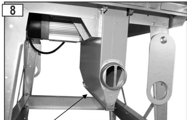
Spanausrutschlitz geschlossen (Betrieb mit Späneabsaugvorrichtung)
