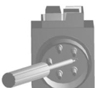
La motoarele trifazate, puteți schimba sensul de rotație prin introducerea unei șurubelnite în fanta prevăzută în acest sens din gulerul de protecție al ștecărului și prin setarea sensului de rotație corect print-o împingere ușoară spre stânga sau spre dreapta.
