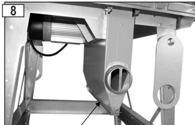
La fente d'éjection des copeaux est fermée (service avec dispositif d'aspiration de copeaux).
