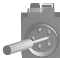
Vous pouvez modifier le sens de rotation sur les scies à moteur à courant triphasé, en agissant avec un tournevis dans la fente prévue à cet effet dans l'embase du connecteur et en réglant le sens de rotation désiré en appuyant légèrement et en tournant vers la gauche ou vers la droite.
