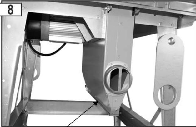
Forgácskidobó rés zárva (üzem forgácsleszívó berendezéssel)
