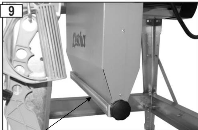
Forgácskidobó rés nyitva (üzem forgácsleszívó berendezéssel)
