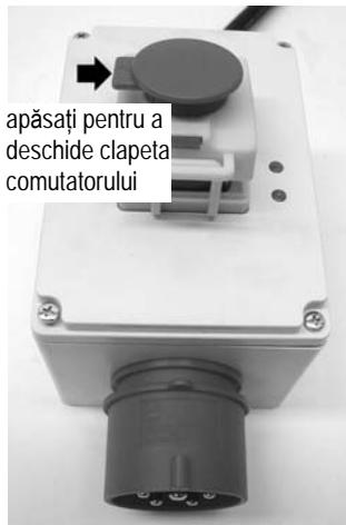
apăsați pentru a deschide clapeta comutatorului
