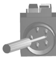
W przypadku silników prądu trójfazowego można zmienić kierunek obrotów przez włożenie śrubokręta do odpowiedniej szczeliny w kołnierzu wtyczki i poprzez lekki nacisk i obrót w prawo lub w lewo ustawić prawidłowy kierunek obrotów.
