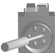
Con i motori trifase, è possibile invertire il senso di rotazione. A questo scopo inserire un cacciavite nell'apposita fessura sul collare della presa e con una leggera pressione, girando verso sinistra o verso destra, regolare il senso di rotazione corretto.
