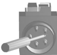
U třífázových motorů můžete směr otáčení kotouče změnit jestliže šroubovák vložíte do vybraného v límci zásuvky a lehkým tlakem vlevo či vpravo nastavíte žádoucí směr otáček.
