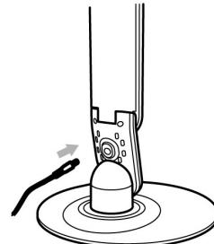
Raccorder l'adaptateur d'alimentation à l'arrière du socle de la lampe
