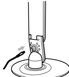
Collegare l'adattatore di alimentazione sul retro della base della lampada.
