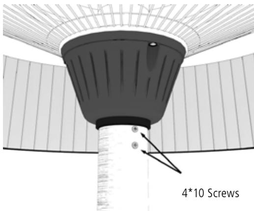
**Step 4:** Pas de lengte van de kabel, bevestig de kabel op de basis met M4\*12 screws.
