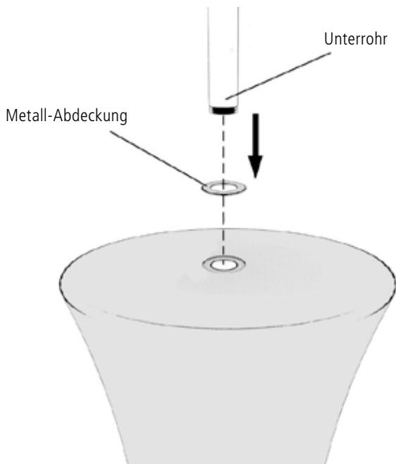
**Schritt 2:** Führen Sie das Netzkabel durch die Basis und das Unterrohr.
