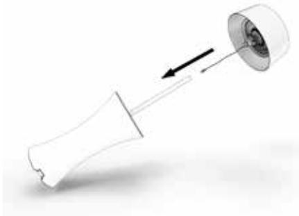
**Schritt 3:** Schieben Sie den Heizungskopf auf das Oberrohr und fixieren Sie es mit den 4\*10mm Schrauben.
