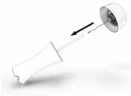
**Step 3:** Inserire la testa del radiatore sul tubo e fissarlo nella posizione corretta usando le apposite viti 4\*10 mm.
