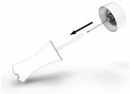
**Step 3:** Schuif de kap van de verwarming op de bovenste stang en bevestig de kap met de 4 schroeven van 10 mm.
