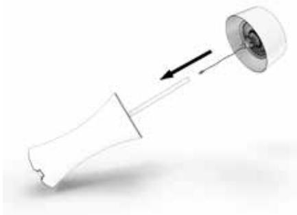
**Étape 3 :** Poussez la tête de chauffage sur le tuyau supérieur et fixez-la avec des 4 vis de 10 mm.
