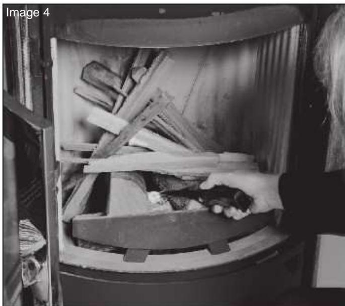
Laissez cette première charge brûler avec un réglage d'air sur position Ouverte jusqu'à ce qu'il ne reste plus que des braises et très peu de flammes (Image 5).
