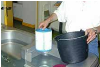
Filter entnehmen und in einen Eimer stellen. Kaltes Wasser begeben bis der Filter bedeckt ist. Decalcit Filter gemäss dem Angegebenem Mischverhältnis begeben.
