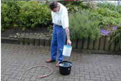
Nach 24 Stunden Filter aus der Reinigungsflüssigkeit nehmen.
