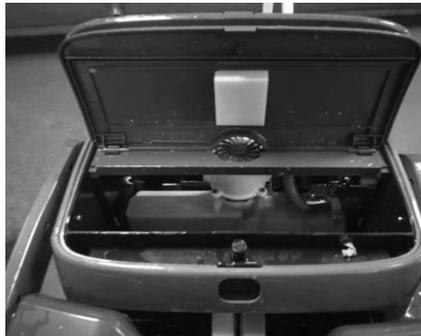
Öffnen Sie die Abdeckung und stecken Sie einen selbstklebenden Schaumstoffkörper an die angezeigte Stelle, ebenso für die andere Seite.
