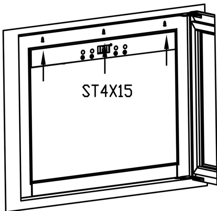
5. A continuación fijar el aparato con tornillos Spax (4 x15) en el soporte superior.
