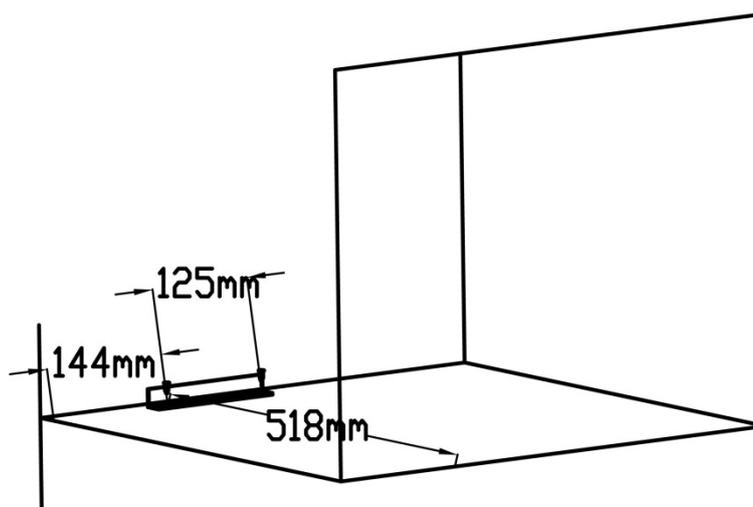
3. Avant encastrer à la kitchenette, visser l'embout de la plaque livrée avec des vis SPAX (4x15) en haut de l'appareil.
