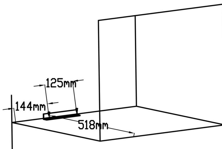
3. Prima del montaggio all'interno di un blocco cucina, avvitare sulla parte superiore del dispositivo il set di piastre contenuto nella fornitura, utilizzando delle viti Spax (4x15).
