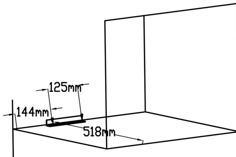
3. Antes del montaje en un módulo de cocina, atornillar la pieza ajustable suministrada con tornillos Spax (4x15) arriba sobre el aparato.
