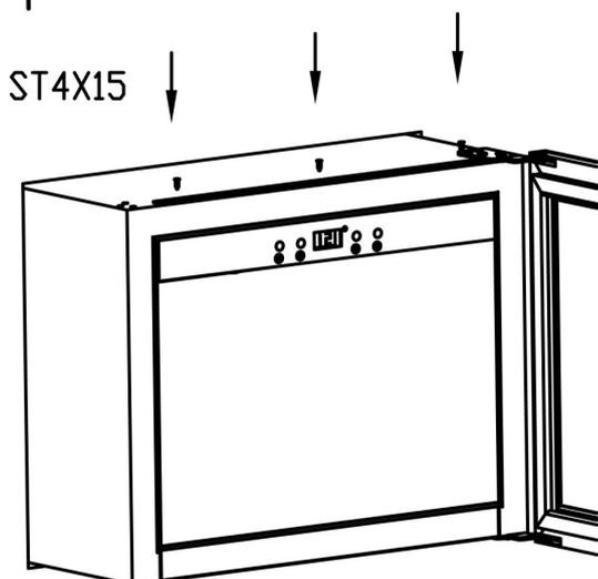
3. Voor inbouw in een keukenblok de meegeleverde plaatbevestiging met spaanplaat Schroeven (4x15) bovenop het apparaat vastschroeven.
