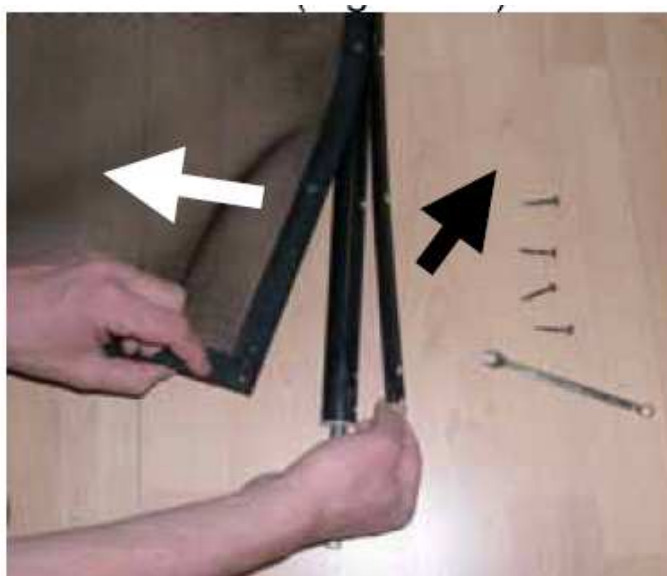
Obrázek 11. Odšroubujte 10 šroubů upevovacích regletů, čímž uvolníte síť
