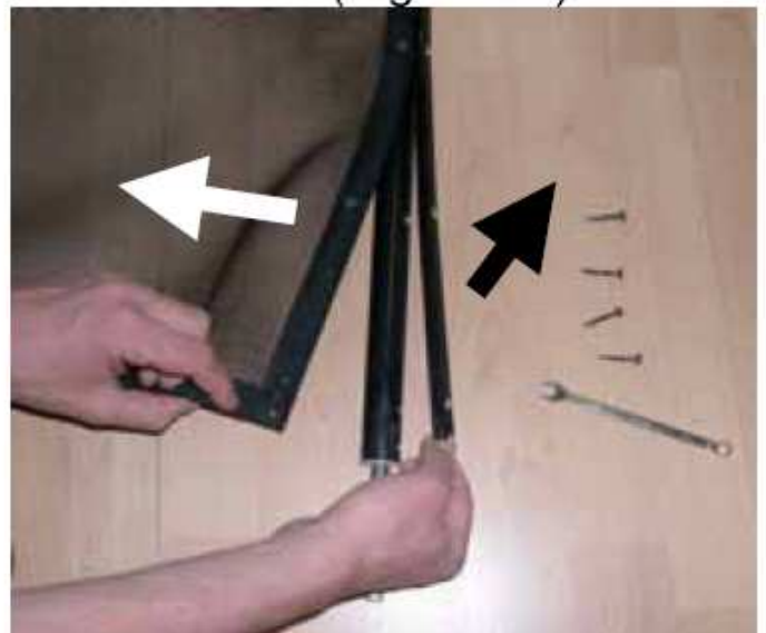
Abb. 11. Lösen der 10 Schrauben an der Fixierleiste des Netzes und Freilegen des Netzes
