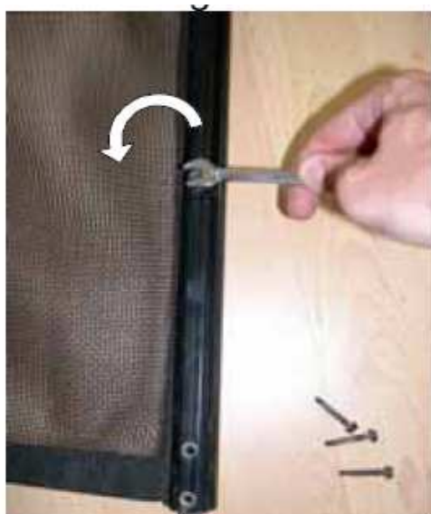
Fig. 11. Svitare le 10 viti dall'asta della rete e staccare la rete
