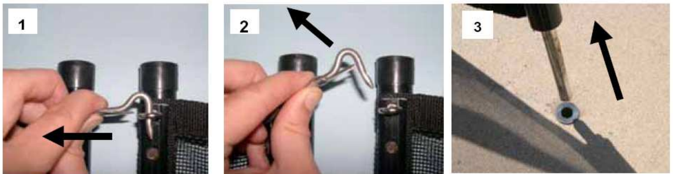
Figuur 12: Werking van de veiligheidshaak
