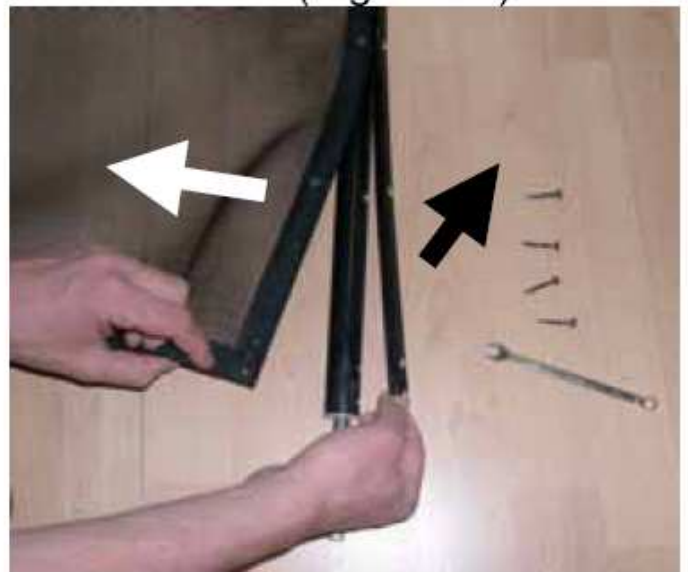
Figuur 11: Het losschroeven van de tien schroeven op de bevestigingsstrip van het net en het blootleggen van het net.
