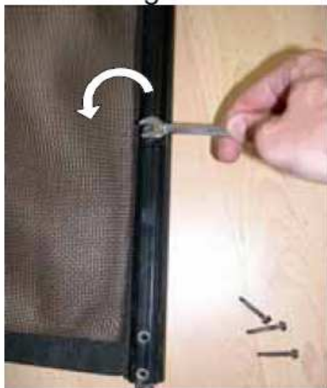
Figura 11. De urubi cele 10 uruburi ale regletei de fixare pentru a elibera plasa
