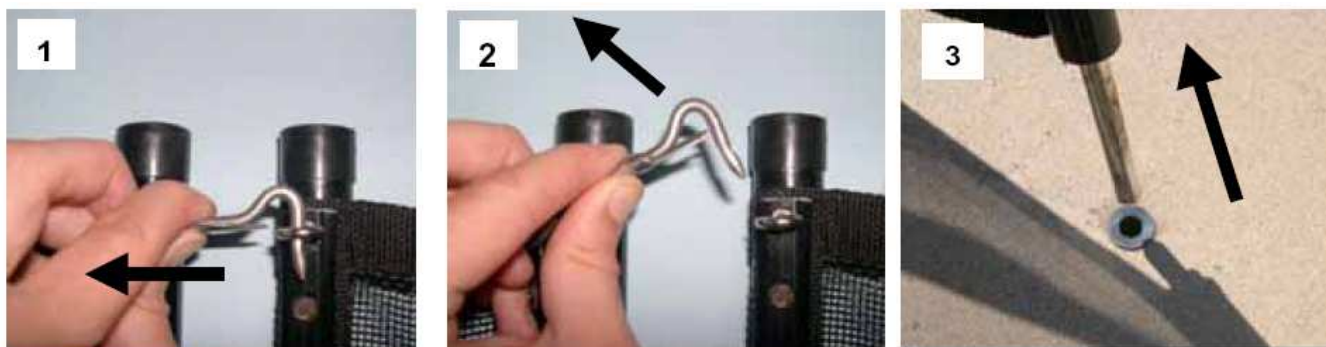
Figura 12. Principiul de func ionare a z vorului de siguran
