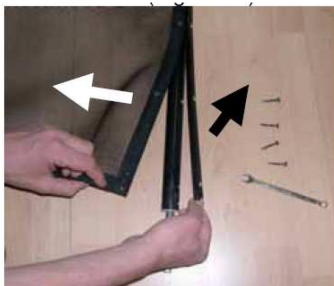
Fig. 11. Svitare le 10 viti dall'asta della rete e staccare la rete
