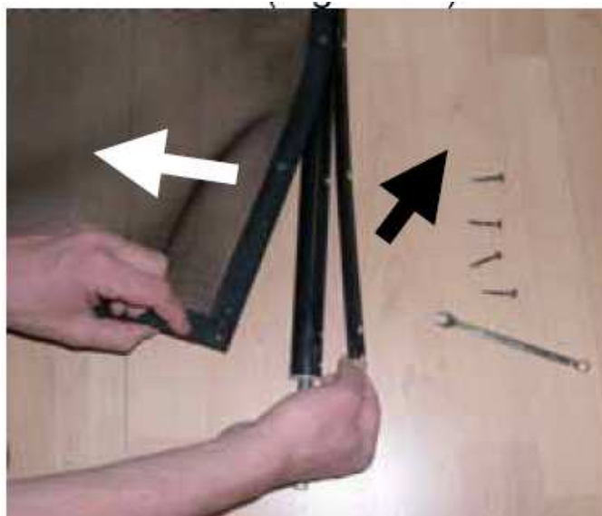
Bild 11. Lossning av de 10 skruvarna på fästlisten till nätet och friläggning av nätet
