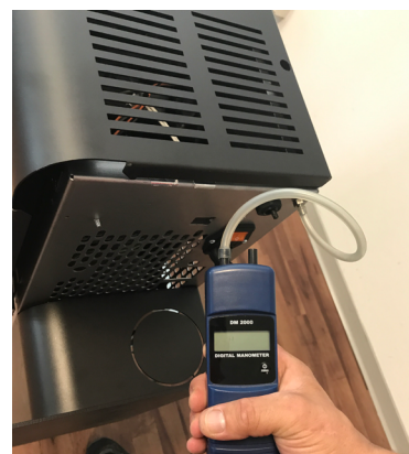
Fig. 47 - Anschluss des Digitaldruckwächters
