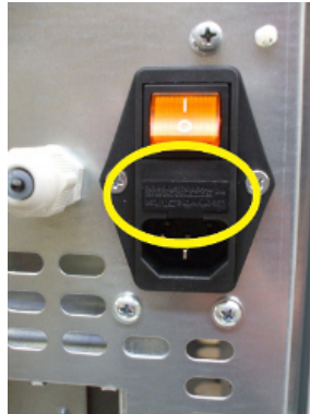
Fig. 82 - Abdeckklappe mit Sicherungen, die ausgewechselt werden müssen
