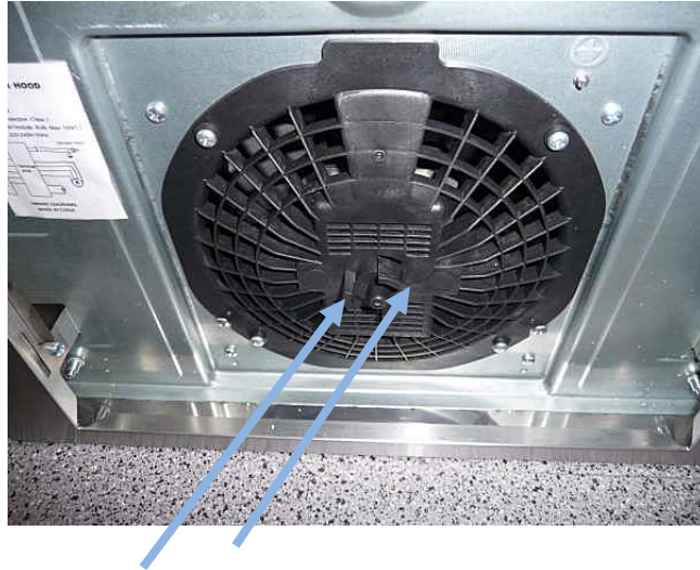
Halteklammer (Haltevorrichtung am Motor)
