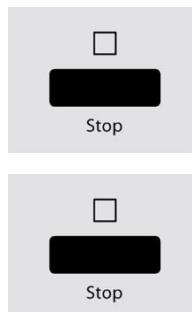
Pulse el botón **Stop** durante tres segundos, hasta que escuche una señal acústica y se ilumine un indicador de funcionamiento. Cuando el bloqueo está activado, el resto de los botones estarán desactivados.
