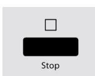
Drukt u de knop **Stop** lang in, totdat u een pieptoon hoort en de functie zichtbaar is in het display. In ontgrendelde stand zijn alle knoppen weer geactiveerd.
