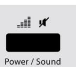
Druk 3 seconden op de knop **Vermogen/Sound** om de Sound (pieptoon) in of uit te schakelen. Beëindigingsberichten van de programma's en waarschuwingsignalen klinken ook bij uitgeschakelde sound.
