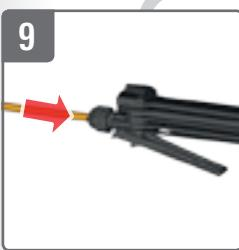
**Sprührohr an Handventil stecken und festziehen**
