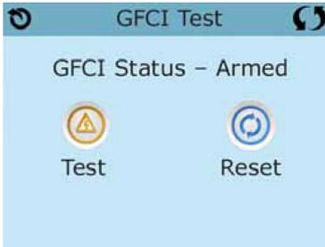
Bei einigen Steuerung: 1 bis 7 Tage nach dem Hochfahren, wird das SPA den FI-Schutzschalter auslösen, um ihn zu testen. (Die Anzahl der Tage wurde bereits im Werk programmiert). Der FI-Schutzschalter muss zurückgesetzt werden, wenn er ausgelöst wurde.
