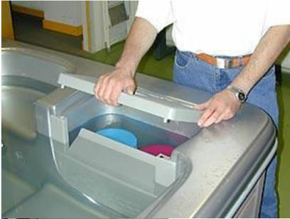
Abdeckung zum Filterraum öffnen
