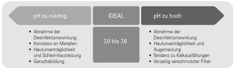
Der pH-Wert wird von verschiedenen Faktoren beeinflusst. Er steigt z.B. nach Zugabe des Frischwassers. Auch die Erhöhung der Wassertemperatur oder die Anreicherung des Wassers mit Luft durch den Sprudeffekt verändert den pH-Wert. Überprüfen Sie deshalb den Wert mindestens einmal pro Woche und korrigieren ihn bei Bedarf mit **pH-Plus** nach oben oder mit **pH-Minus** nach unten. Die Dosierung des Granulats erfolgt direkt ins Whirlpoolwasser.
