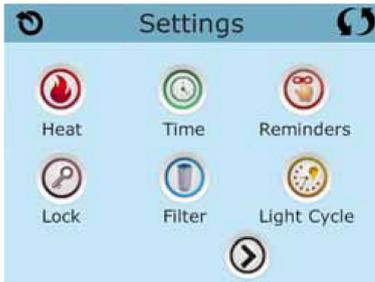
Das Symbol "Heizung"
