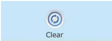
\* Manche Nachrichten können auf dem Bedienfeld zurückge-setzt werden. Fehlermeldungen die zurückgesetzt werden können erscheinen mit einem "Lösch-Symbol" unten auf dem Bildschirm Nachrichten. Drücken Sie auf das Lösch-Symbol, um die Meldung zurückzusetzen.
