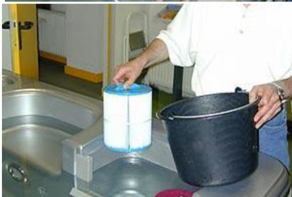
Retirer le filtre et le placer dans un seau. Ajouter de l'eau froide jusqu'à ce que le filtre soit recouvert. Ajouter du Decalcit Filtre conformément au rapport de mélange indiqué.
