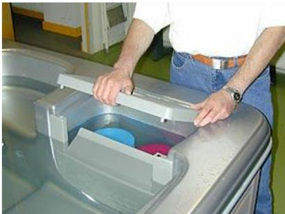
Ouvrir le recouvrement du logement du filtre
