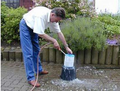
Bien rincer le filtre avec un tuyau d'arrosage. Aucune mousse ne doit plus s'échapper du filtre.
