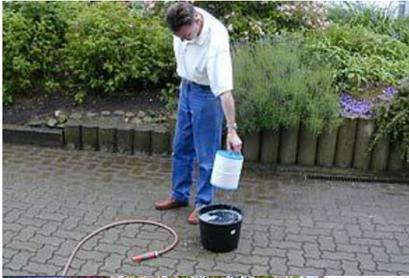
Retirer le filtre du liquide de nettoyage au bout de 24 heures.
