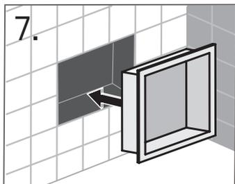
Setzen Sie den Edelstahleinsatz ein. Prüfen Sie dabei die korrekte lotrechte und waagerechte Ausrichtung des Einsatzes mit einer Wasserwaage. Füllen Sie die Lücken zwischen der Fliese und dem Flansch des Edelstahleinsatzes mit Fugenmasse oder Silikon.
