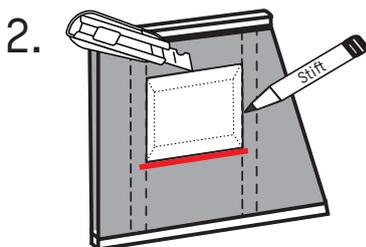
Zeichnen Sie die Umrisse des Edelstahleinsatzes an die Wand und schneiden Sie eine Öffnung in die Wand.
