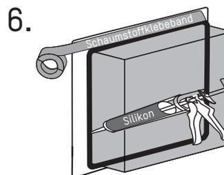
Tragen Sie eine durchgehende, dünne Silikonnaht auf der Innenseite des Flansches auf der Rückseite des Edelstahleinsatzes auf. Verwenden Sie doppelseitiges Schaumstoffklebeband mit einer Breite von 1/4" und kleben Sie dieses auf den Flansch.
