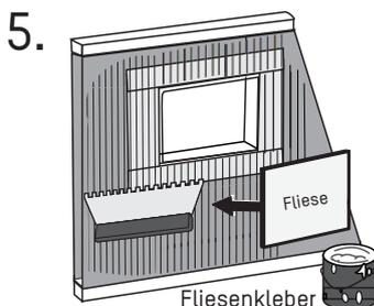
Tragen Sie Fliesenkleber auf und setzen Sie Ihre Fliesen auf die Wand. Wir empfehlen eine symmetrische Verlegung der Fliesen rund um den Edelstahleinsatz. Wenn die Fliesen bündig mit der Fuge des Edelstahleinsatzes verlegt werden, ergibt sich ein besonders schönes Verlegebild.
