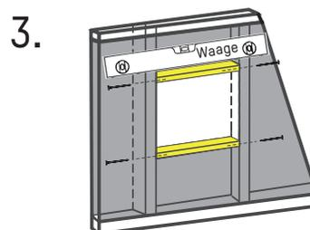
Bauen Sie zur Stabilisation einen Befestigungsrahmen, auf dem der Einsatz später befestigt werden kann und kontrollieren Sie nochmals mit der Wasserwaage. Reinigen Sie die Ausnehmung und prüfen Sie, ob der Einsatz problemlos in die Öffnung passt.
