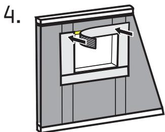
Bringen Sie die selbstklebende, wasserfeste Abdichtungsbahn auf. Beginnen Sie hier mit den beiden Seiten und achten Sie darauf, dass anschließend die horizontalen Abdichtungsbahnen die seitlichen überlappen. Drücken Sie die Abdichtungsbahn vorsichtig gegen die Wand, um die Dichtungsmasse gleichmäßig zu verteilen und Unebenheiten zu vermeiden. Verwenden Sie kein Silikon oder anderes Abdichtungsmaterial.
