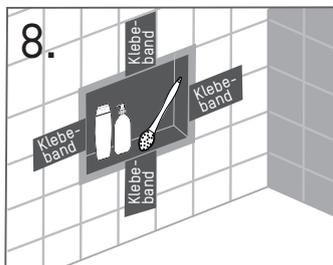
Fixieren Sie den Flansch vorübergehend mit Klebeband, bis das Silikon ausgehärtet ist.
