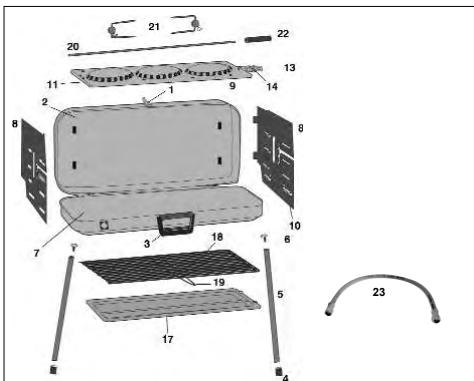
Posez la mallette à plat sur le sol. Ouvrez le levier de fermeture (1), soulevez le couvercle (2) et retirez les différentes pièces de la mallette.
