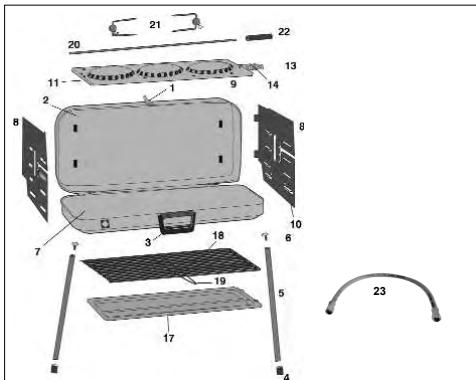
Verschlusshebel (1) öffnen, den Deckel (2) nach oben klappen und die losen Einzelteile aus dem Koffer herausnehmen.
