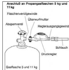
Kontrollieren Sie den ordnungsgemäßen Zustand der Dichtung im Flaschenventil (auch bei jedem Flaschenwechsel)
