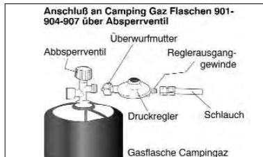
Kontrollieren Sie den ordnungsgemäßen Zustand der Dichtung im Flaschenventil (auch bei jedem Flaschenwechsel).
