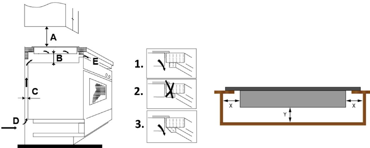
**D = BELÜFTUNGSSCHLITZ / E = LUFTAUSSLASS**
