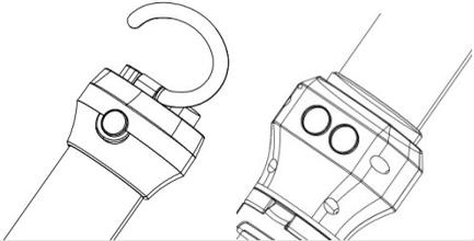
**Magnetische Ansaugung:** der Lampenkopf und der Griff sind mit Magneten ausgestattet, die auf der Metalloberfläche absorbiert werden können
