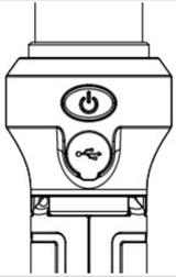
**Verwendung:** Es gibt drei Modi für das Licht: Drücke den Schalter einmal, das helle Licht geht an; drücke das zweite Mal, das dunklere weiße Licht geht an. Drücke zweimal schnell den Schalter so leuchtet es rot und ein weiteres mal den Schalter drücken, dann geht die Lampe aus
