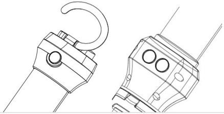
**Aspiration magnétique :** la tête et la poignée de la lampe sont dotées d'aimants qui peuvent être absorbés par la surface métallique.
