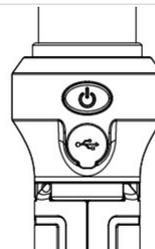
Utilisation : il y a trois modes d'éclairage : appuie une fois sur l'interrupteur, la lumière claire s'allume ; appuie une deuxième fois, la lumière blanche plus sombre s'allume. appuie deux fois rapidement sur l'interrupteur pour qu'il s'allume en rouge et appuie une autre fois sur l'interrupteur, la lampe s'éteint alors
