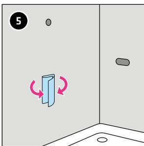
Plier le feutre d'étanchéité. La Fixbox à encastrer doit arriver à fleur de mur.
