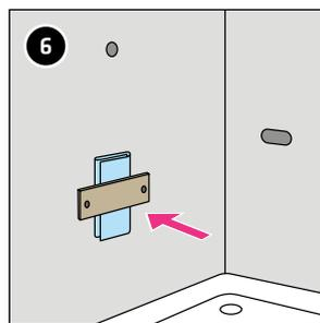
Fixer le dispositif de fixation au moyen des vis.
