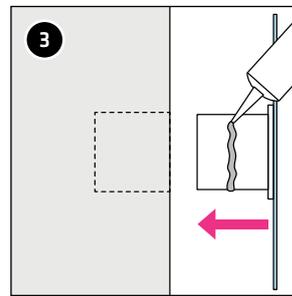
Nettoyer la zone à coller sur la partie à encastrer de la Fixbox, y appliquer la colle au centre et l'enfoncer dans le trou.
