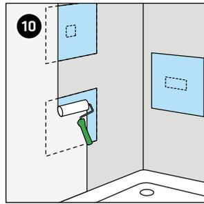
Appliquer l'étanchéité composite sur le mur en y incorporant le feutre prémonté. Respecter les indications du fournisseur.
