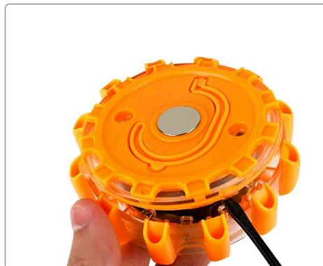
Heben Sie vorsichtig mit einem Schraubenzieher die Abdeckung der Warnleuchte an
