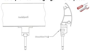
Sollte das Ausfallprofil im eingefahrenen Zustand nicht richtig mit dem Dach abschließen kann man dies einstellen. Hierzu muss man das Ausfallprofil entlasten (nach vorne kippen, Markise ganz ausgefahren) und die Inbusschraube rein oder raus drehen. Wenn man die Schraube weiter reindreht so kippt das Profil nach vorne und beim rausdrehen nach hinten. (beide Seiten einstellen!!!)
