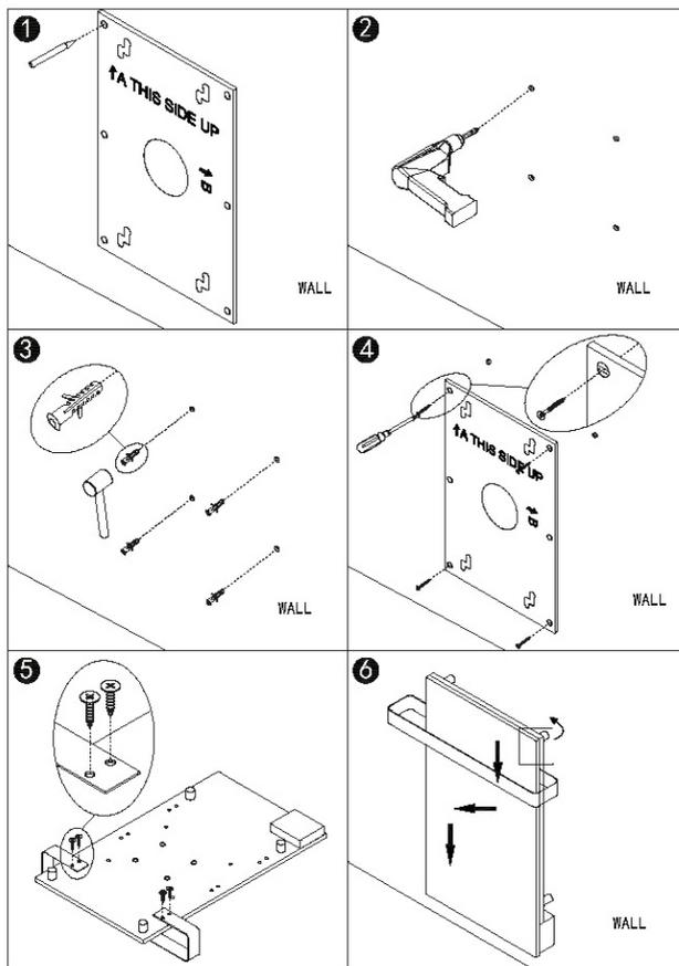
1. Utilisez le gabarit fourni pour marquer l'emplacement des trous sur le mur.
