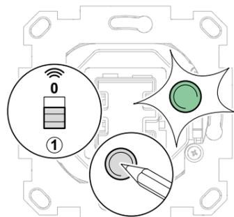
Schalten Sie die WiFi-Funktion ein („1“). Die grüne LED flackert kurz und beginnt dann schnell zu blinken. Sobald die LED schnell blinkt, ist das Gerät bereit zur Anmeldung. Drücken Sie auf „Gerät suchen“. Wenn die LED nicht schnell blinkt: Drücken Sie die WiFi-Lerntaste min. 3 Sekunden und max. 6 Sekunden lang. Die App sucht den Rollladen-Schalter.
