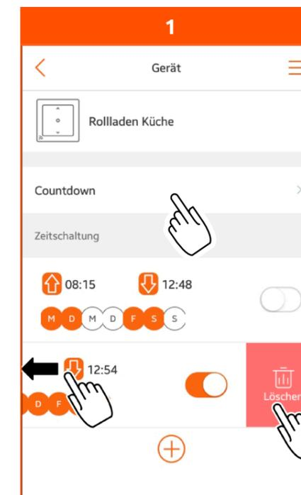
Wenn Sie ein Schaltprogramm nicht mehr verwenden wollen: Löschen Sie das Schaltprogramm, indem Sie es nach links aus dem Bildschirm herauschieben. Bestätigen Sie das Löschen.
