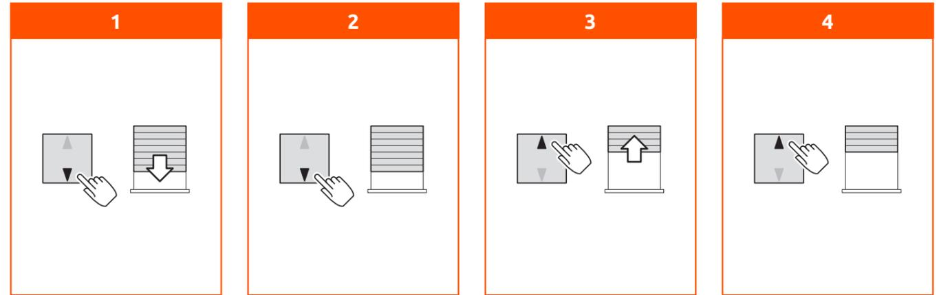
Um den Rollladen zu schließen: Tippen Sie die Taste „schließen“. Der Rollladen senkt sich. Warten Sie, bis der Rollladen ganz geschlossen ist und der Antrieb abschaltet.
