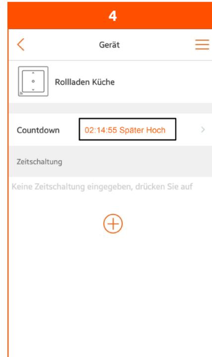
Das Ergebnis wird angezeigt: Nach Ablauf der eingestellten Zeit wird der Rolladen-Schalter den Rollladen schließen.
