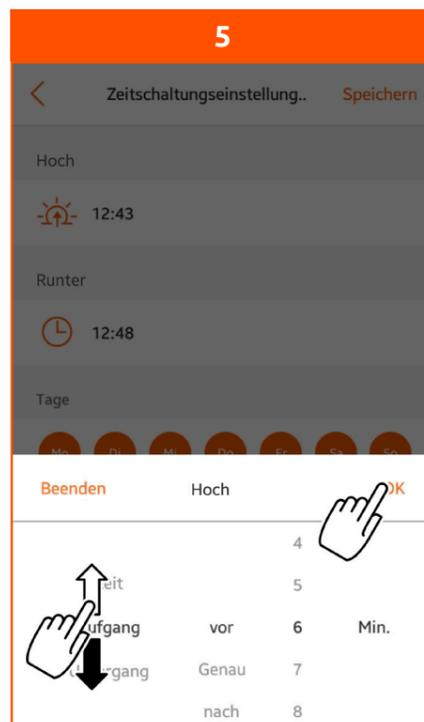
Alternative: Um den Rollladen bei Sonnenaufgang zu öffnen, drücken Sie „Aufgang“. Für das Schließen bei Sonnenuntergang wählen Sie „Untergang“. Bestätigen Sie mit „OK“.
