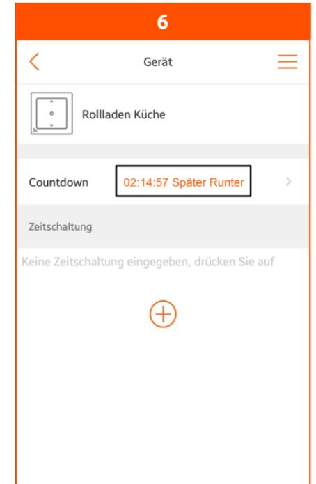
Das Ergebnis wird angezeigt: Nach Ablauf der eingestellten Zeit wird der Rollladen-Schalter den Rollladen schließen.
