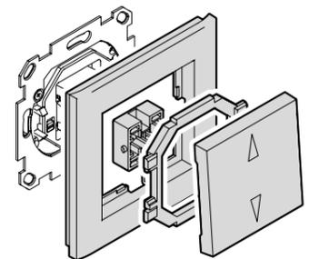
Montieren Sie jetzt den Rahmen und die Wippe. Verwenden Sie zur Montage des Rahmens ggf. den passenden Rahmen-Adapter. Siehe „Passende Adapter wählen“.
