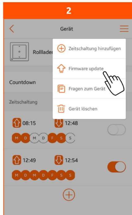
Wählen Sie „Firmware update“. Es kann ein paar Sekunden dauern, bis die aktuell aufgespielte Firmware geprüft und angezeigt wird.
