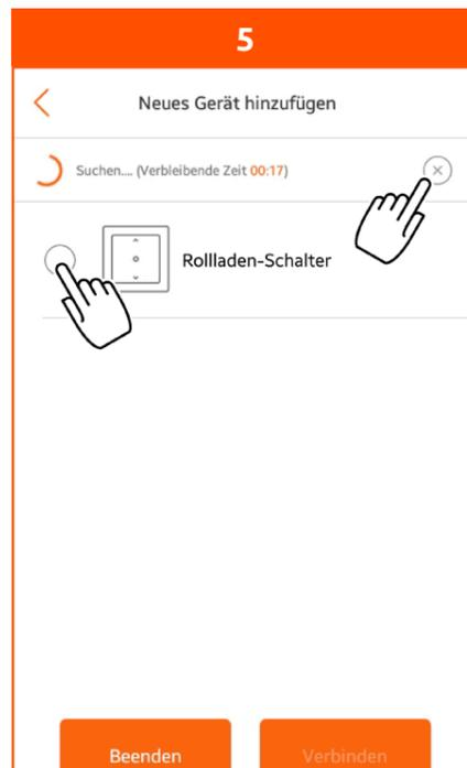
Sobald die App den Rollladen-Schalter gefunden hat, wird er angezeigt. Sie können die Suchzeit ablaufen lassen oder die Suche jetzt beenden: Drücken Sie „x“. Wählen Sie den Rollladen-Schalter aus.
