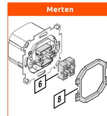
Hebeln Sie vorsichtig die Original-Wippenaufnahme aus dem Wechselschalter heraus.
