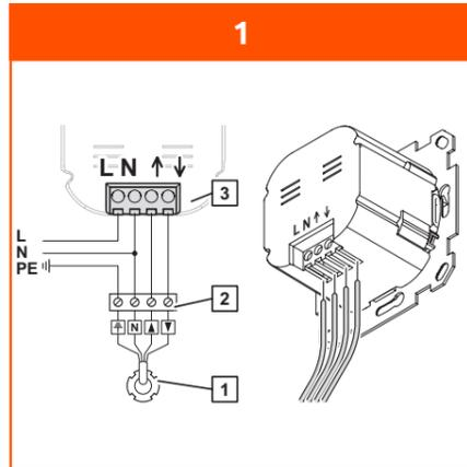
Schließen Sie den Rollladen-Schalter an:
