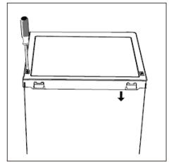
Entfernen Sie die Türdichtung, drehen sie diese und installieren Sie sie wieder.
