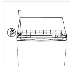
Setzen Sie die Abdeckung wieder auf und schrauben Sie diese fest.
