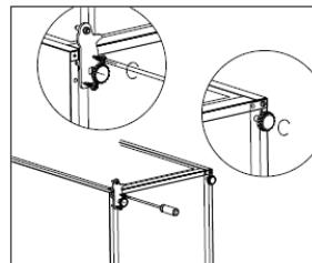
Réinstallez la porte. Assurez-vous que la porte est correctement alignée et que les joints ferment bien avant de serrer la charnière.
