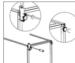
Setzen Sie die Türe wieder ein. Stellen Sie sicher, dass die Türe sauber ausgerichtet ist und die Dichtungen auf allen Seiten gut schliessen, bevor Sie das obere Scharnier anziehen.
