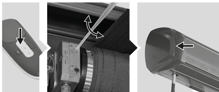
Wenn der Motor weiter brummt, nachdem die Markise vollständig eingefahren ist, drehen Sie die weiße Buchse in „-“-Richtung. Stellen Sie sicher, dass das Motorgeräusch sofort stoppt, nachdem die Markise vollständig geschlossen wurde.
