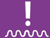
Diese Meldung kann nur auf einem System erscheinen, das einen Wasserstandssensor verwendet. Sie erscheint, wenn der Wasserspiegel zu niedrig oder der Wasserstandssensor nicht angeschlossen ist und verschwindet automatisch, wenn der Wasserstand wieder ausreichend ist.
