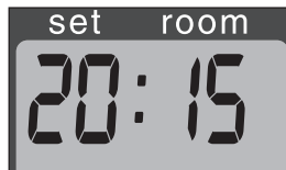
F: När den 4-siffriga displayen upphör att blinka, har inställningen lästs på det angivna värdet.
