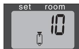
K: Als 'FUEL' indicatie brandt, ziet u in het informatiedisplay voor hoeveel minuten u nog brandstof hebt.
