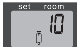
K: Når FUEL indikatoren lyser, vil informationsdisplayet vise hvor mange minutters brændtid der er tilbage i tanken.
