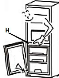
7. Platzieren Sie die Kühlschranktür auf dem mittleren Scharnier; der Scharnierstift muss sich in der Öffnung unten an der Kühlschranktür befinden. Türe schließen; danach bringen Sie das obere Scharnier an der gegenüberliegenden Seite an. Der obere Scharnierstift muss sich in der Öffnung oben an der Kühlschranktür befinden. Bringen Sie die Scharnierabdeckung wieder an.
