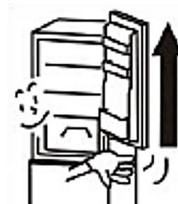
3. Schrauben Sie das mittlere Scharnier ab (C). Nehmen Sie die Tür nach oben vom unteren Scharnier ab.
