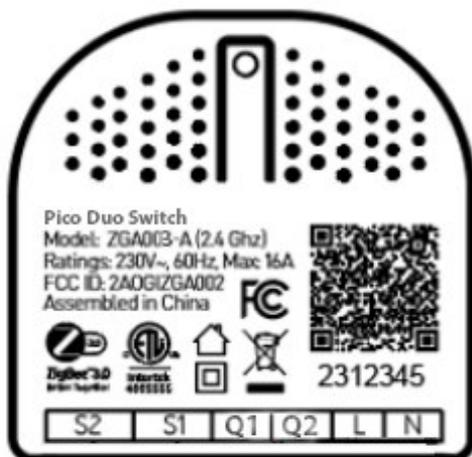
**Aeotec Pico Duo Switch** (<https://aeotec.com/smarthings/>) ist für die Steuerung von Geräten mit einem beliebigen Zigbee 3.0-Hub über eine physische und drahtlose Verbindung konzipiert. Er wird mit Zigbee-Technologie betrieben.
