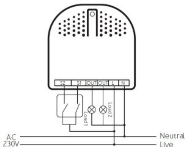
Fig. 1: Verwendung von Doppel-Tastern oder separaten einpoligen Kippschaltern
