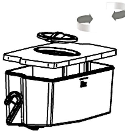
3. Reinigen Sie alle Teile (Wassertank, Abdeckung, Deckel) mit warmem Seifenwasser. Spülen Sie dann alles mit klarem Wasser gut ab und trocknen Sie alle Teile gründlich.
