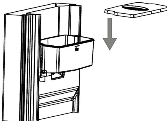
5. Install the lid properly (s. fig. on the right).
