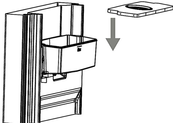
3. Setzen Sie dann den Deckel wieder ordnungsgemäß ein (s. Abb. rechts).
