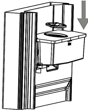
4. Überprüfen Sie, ob der Wassertank ordnungsgemäß in der Gerätetür sitzt.
