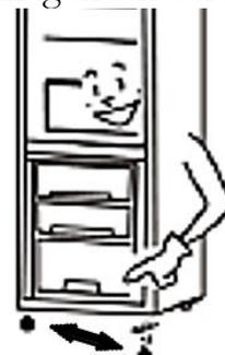
5. Entfernen Sie die Scharnierstifte (D) aus der Unterseite der Kühlschrank- (E) und Gefrierfachtür (F). Bringen Sie den mitgelieferten Austausch-Scharnierstift an der gegenüberliegenden Seite an (G).
