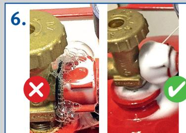
6. Am Schluss immer kontrollieren, ob der Anschluss dicht ist – der aufgesprühte Schaum darf keine Blasen werfen
