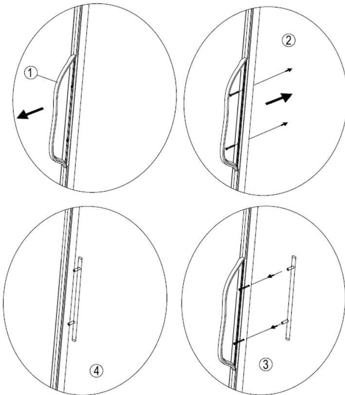
Let u er a.u.b. op dat u het meegeleverde roestvrijstalen handvat voor de eerste ingebruikname aan de deur van het apparaat vastschroeft. Schuif daarbij het dichtingsrubber aan de achterkant opzij, om zo de voorgeboorde gaten vrij te maken. Met behulp van de meegeleverde schroeven kunt u het handvat aan de deur bevestigen.
