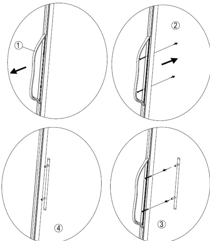
Veuillez noter que, avant la première utilisation, vous devez visser la poignée en inox jointe à la porte de l'appareil. Pour ce faire, poussez le joint en caoutchouc se trouvant à l'arrière de la porte vers le côté pour dégager les trous pré-percés. Vous pouvez alors monter la poignée sur la porte avec les vis jointes.
