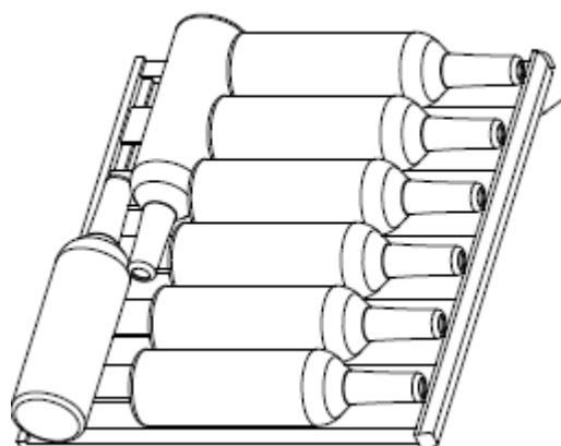
Om een houten bewaarplateau eruit te nemen, haalt u eerst de flessen eruit. Dan tilt u het plateau lichtjes op en trekt het er dan uit. (Eventueel eerst schroeven losdraaien).
