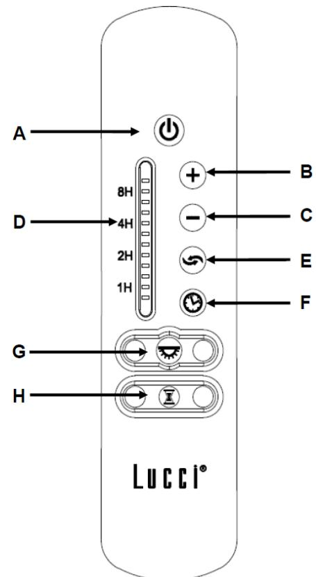
: TASTE VENTILATOR-TIMER (F): Diese Taste drücken, um die Programmierung des Timers zum automatischen Abschalten des Ventilators vorzunehmen oder die Timereinstellung zu löschen. Drücken Sie die Taste, um den Timer auf 1h → 2h → 4h → 8h → Timer AUS zu stellen. Die LED-Anzeige (D) zeigt die programmierte Einstellung des Timers an (1H, 2H, 4H und 8H).
