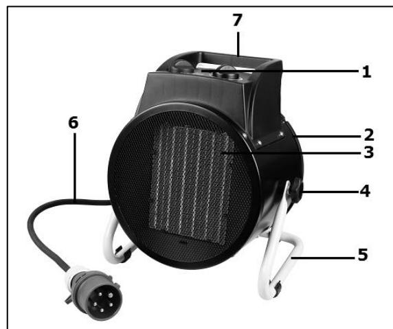
En desserrant légèrement les boutons de réglage (4), vous pouvez faire basculer l'appareil dans son cadre et modifier ainsi la direction de la sortie d'air. Ne l'orientez pas vers le bas vers un sol inflammable ou sensible à la chaleur ! L'étendue du basculement est limitée pour des raisons de sécurité. Resserrez fermement les boutons de réglage avant de remettre l'appareil en marche !
