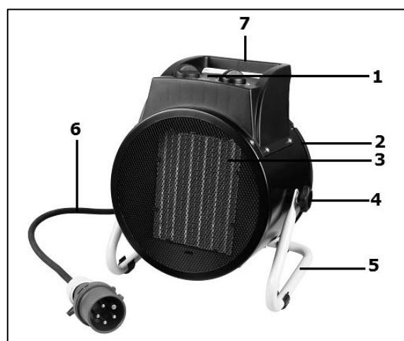
Dacă slăbiți strânsarea butonului de reglare (4), puteți modifica poziția radiatorului și stabili, astfel, direcția fluxului de aer. Nu îndreptați radiatorul înspre podele inflamabile sau sensibile la căldură! Din motive de siguranță, capacitatea de înclinare este limitată. Strângeți din nou butonul de siguranță înainte de a repune în funcțiune radiatorul!
