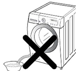
➤ Das Schlauchauslass des Wasserabflussschlauchs **darf nicht** in Wasser eingetaucht sein.
