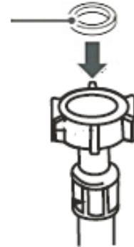
2. Befestigen Sie das **gerade** Ende des Wasserzulaufschlauchs an dem entsprechenden Wasseranschluss (s. Abb. rechts).
