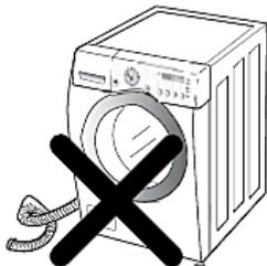
➤ Der Wasserabflussschlauch **darf nicht** verdreht sein.
